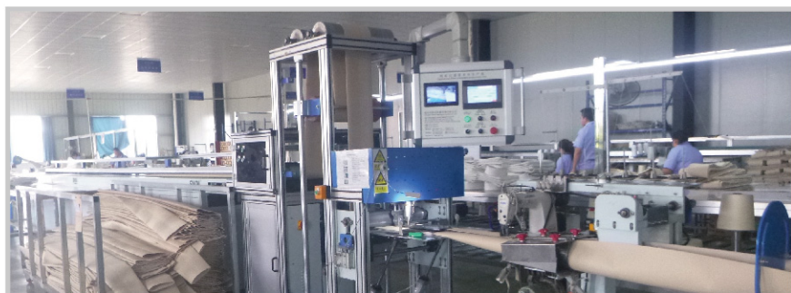
全自动热熔、线缝生产线 Automatic production line
